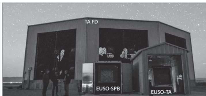
Fig. 3. Il telescopio EUSO-TA, sul sito di Telescope Array, Black Rock Mesa, Utah (USA). Il rivelatore è costituito da un sistema ottico con due lenti di Fresnel e una superficie focale di 2340 pixel.
