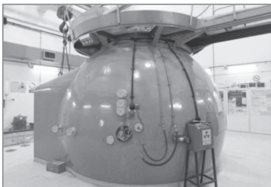
TAPIRO (acronimo di TAratura PI-la Rapida a potenza zero) è un reattore nucleare di ricerca situato presso il Centro ricerche Casaccia dell'ENEA, vicino a Roma.
